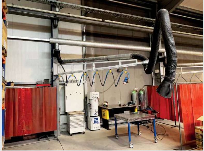
Duvar braketli ve kılavuz raylı emiş kolu
