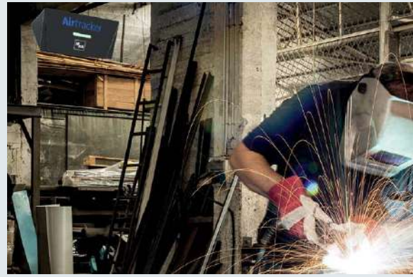
AirTracker oda izleme sistemi örneğin merkezi bir konumda tavana monte edilir.
