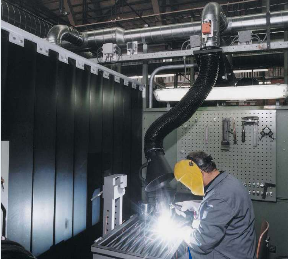
Uygulama örneği: Kaynak kabiniinde teleskopik emiş kolu
